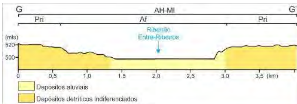
Figura 65 Perfil topográfico G-G' que exibe parte da área do modelado de Acumulação fluvial (Af).
